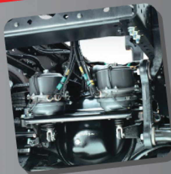
ระบบกันสะเทือน หมอนพาราโบลาและโช๊คอัพ 2 จังหวะพร้อมเหล็กกันโคลง
