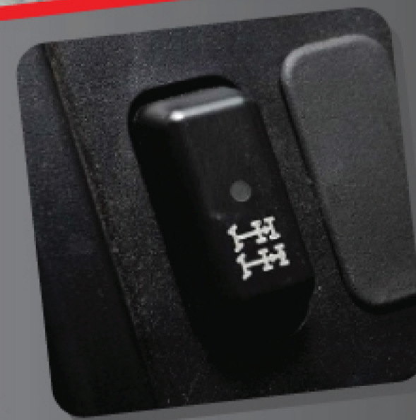
ระบบล็อกเฟืองท้าย ด้วยระบบฟูลติฟล็อก ช่วยส่งกำลังขับเคลื่อนขณะล้อยึดหล่ม
